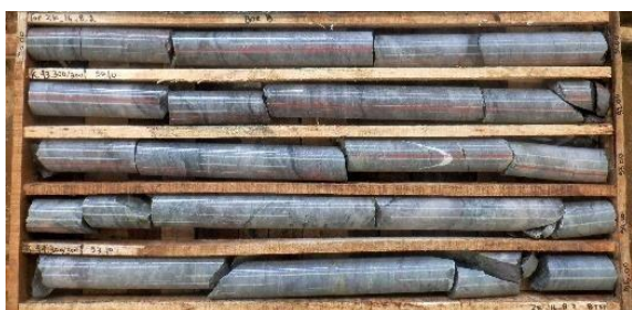
Gambar 10. Pada lubang bor nomor A_01, inti bor kedalaman 90,00 s.d 95,00 meter, memperlihatkan metalimestone , termarmirkan sangat kuat, alterasi klorit sangat lemah, terdapat veinlet epidot dan klorit, veinlet kalsit-kuarsa di kedalaman 92,75 meter, terdapat pirit
