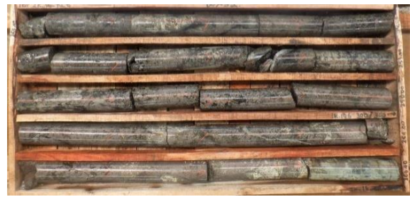
Gambar 11. Pada lubang bor nomor A_01, inti bor kedalaman 256,50 s.d 258,00 meter, memperlihatkan batugamping, teralterasi sedang oleh klinopiroksen - wollastonit, alterasi sedang oleh klorit skarn, pelindian mineral pirhotit, veinlet yang terisi pirhotit di kedalaman 257,20 meter, veinlet silika di kedalaman 258,00 meter, pirhotit mendominasi, Pb-Zn skarn <1%
