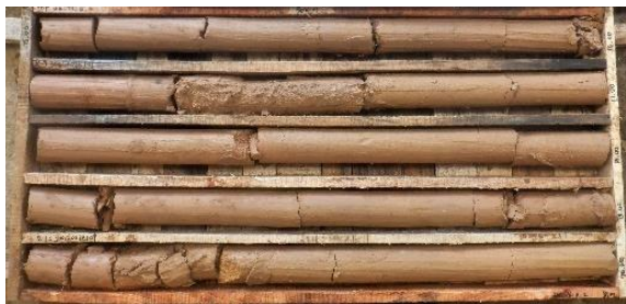
Gambar 8. Pada lubang bor nomor A_01, inti bor kedalaman 15,00 s.d 20,00 meter, memperlihatkan tufa kristal, teralterasi kuat, mineral alterasi berupa kaolin-smektit, terdapat sedikit hematit dan mangan, sangat lapuk
