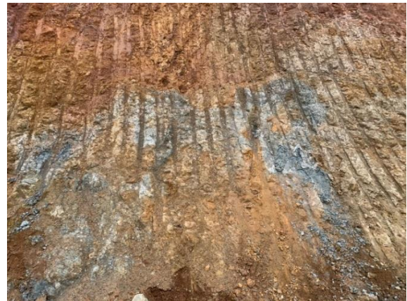
Gambar 16. Singkapan marbellized pada dinding Pit berwarna abu cerah dengan komposisi mineral kalsit
