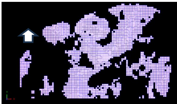
Gambar 14. Blok model estimasi sumber daya berdasarkan CoG bauxite Al_2O_3 > 35\% , RSiO_2 < 8\% , dan TSiO_2 \leq 30\%
