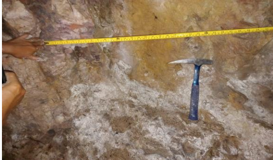
Gambar 14. Singkapan urat kuarsa, coklat keputihan, rodokrosit, kristalin-banded, galena / sfalerit, pirit (lokasi SDK23M004R)
