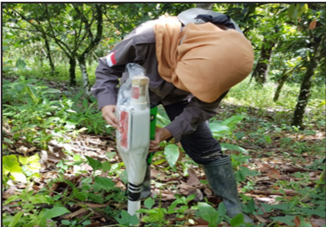
Pengambilan data Audio Magneto Telluric (AMT) di daerah Panas Bumi Toro dan sekitarnya, Kabupaten Sigi, Provinsi Sulawesi Tengah
