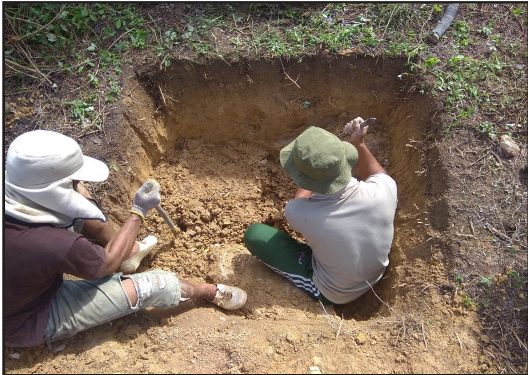
Pembuatan Sumur Uji pada Eksplorasi Kuarsit, Kecamatan Kluet Tengah, Kabupaten Aceh Selatan, Provinsi Aceh (Irwan Muksin, 2021)
