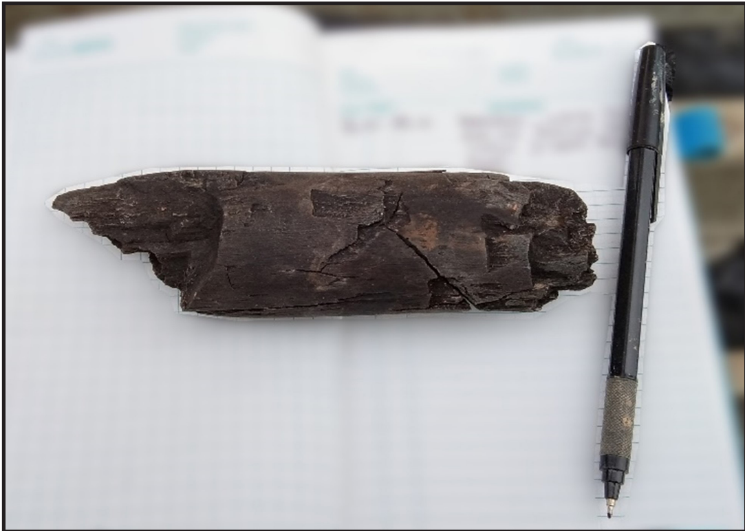
Kenampakan Percontoh Inti Bor Batubara yang Masih Memiliki Kenampakan Struktur Kayu di Desa Jangga, Kabupaten Batang Hari, Provinsi Jambi (Feddi Ervianna, 2021)
