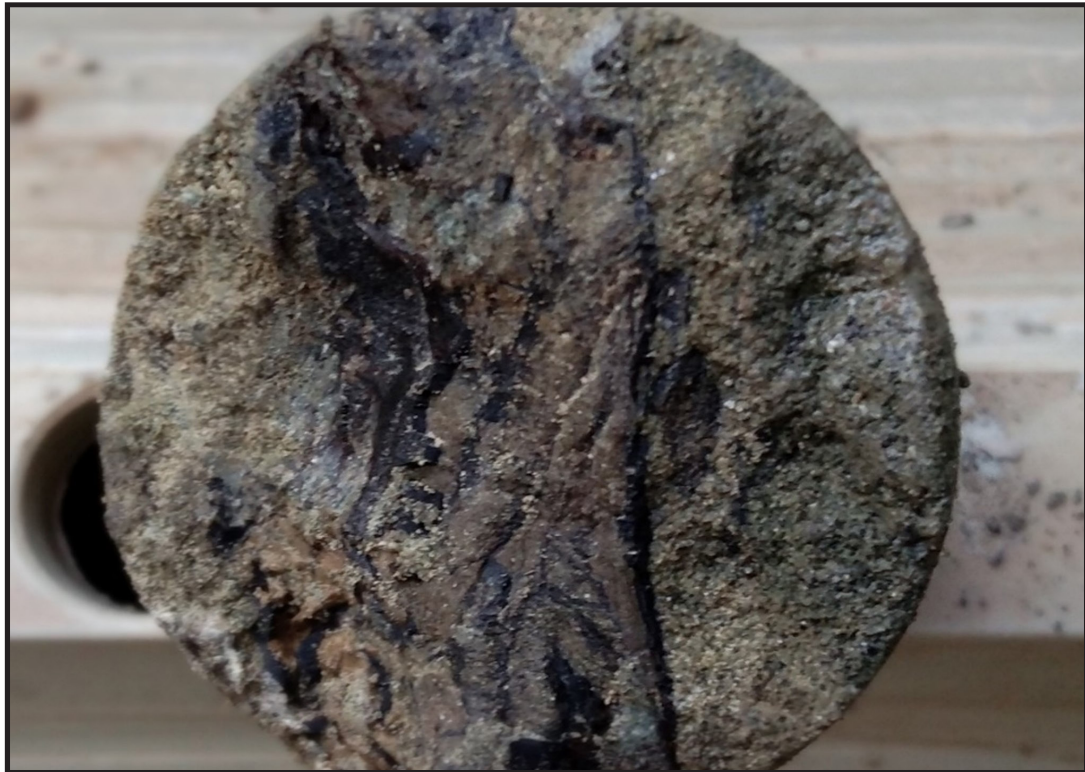
Kenampakan Pita-pita Karbonan dalam Percontoh Inti Bor Batupasir di Desa Jangga, Kabupaten Batang Hari, Provinsi Jambi (Feddi Ervianna, 2021)
