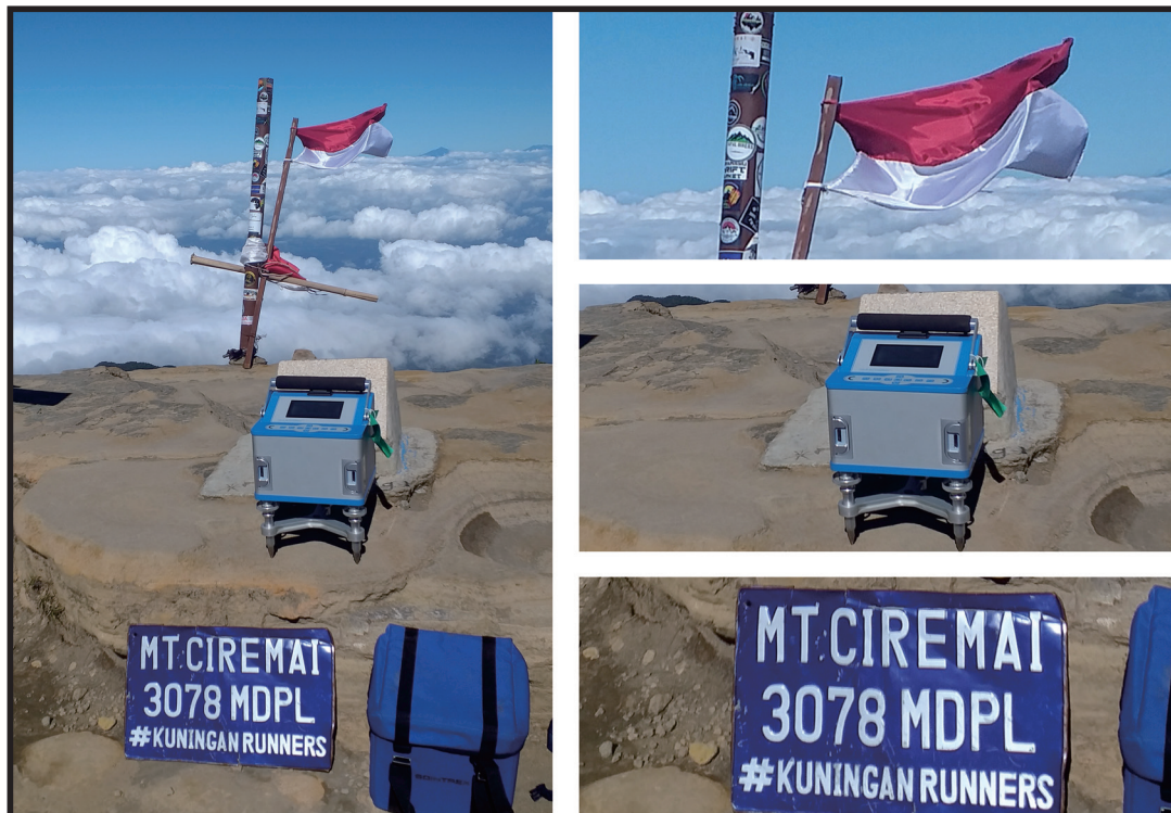
Pengukuran Gaya Berat di Puncak Gunung Ciremai. Titik Ukur ini Berada di Ketinggian 3078 mdpl, Puncak Tertinggi di Jawa Barat dan Merupakan Titik Ukur Gaya Berat Tertinggi di Indonesia, Wilayah Kerja Panas Bumi Gunung Ciremai, Kabupaten Kuningan, Provinsi Jawa Barat (Ratna Dewi, 2021)
