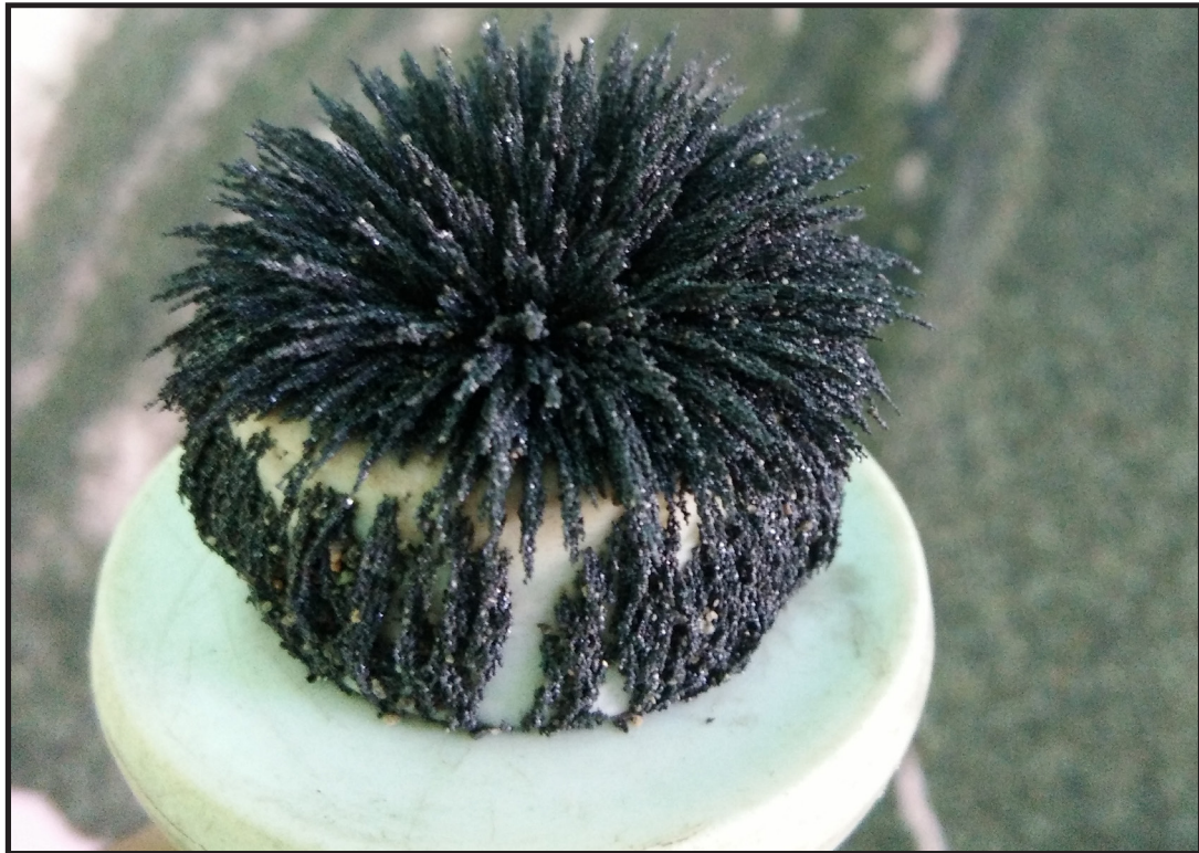
Kenampakan Magnetit Hasil Pemisahan dari Mineral Lainnya dengan Menggunakan Alat Separator Magnetik Manual dengan Daya 300 Gauss dalam Kegiatan Prospeksi Pasir Besi di Kecamatan Lunyuk, Kabupaten Sumbawa, Provinsi Nusa Tenggara Barat (Sulaeman, 2021)
