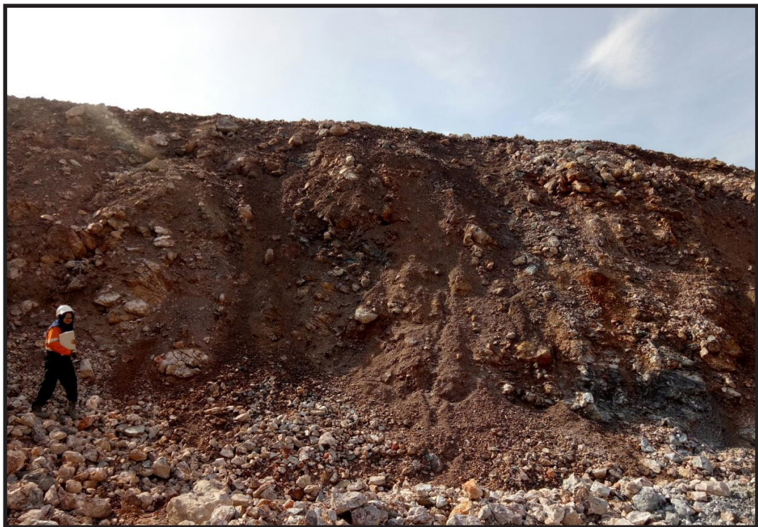
Proses penambangan yang dominan dilakukan pada zona alterasi kuarsa+kaolinit+dikit, dengan tingkat oksidasi kuat. Mineral oksida berupa gutit dan hematit (Nada Salsabila Deva, 2020)
