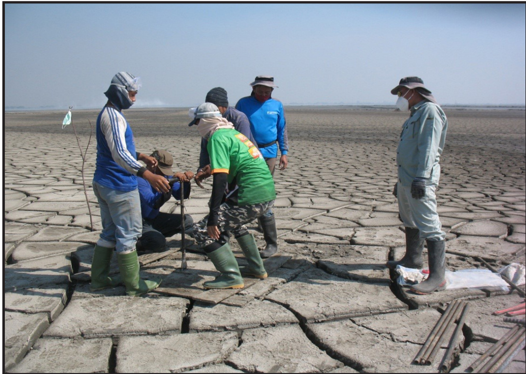
Kegiatan pengeboran mineral ekonomis di lumpur lapindo dengan menggunakan Hand Auger, Kabupaten Sidoarjo, Provinsi Jawa Timur (Irwan Muksin, 2020)
