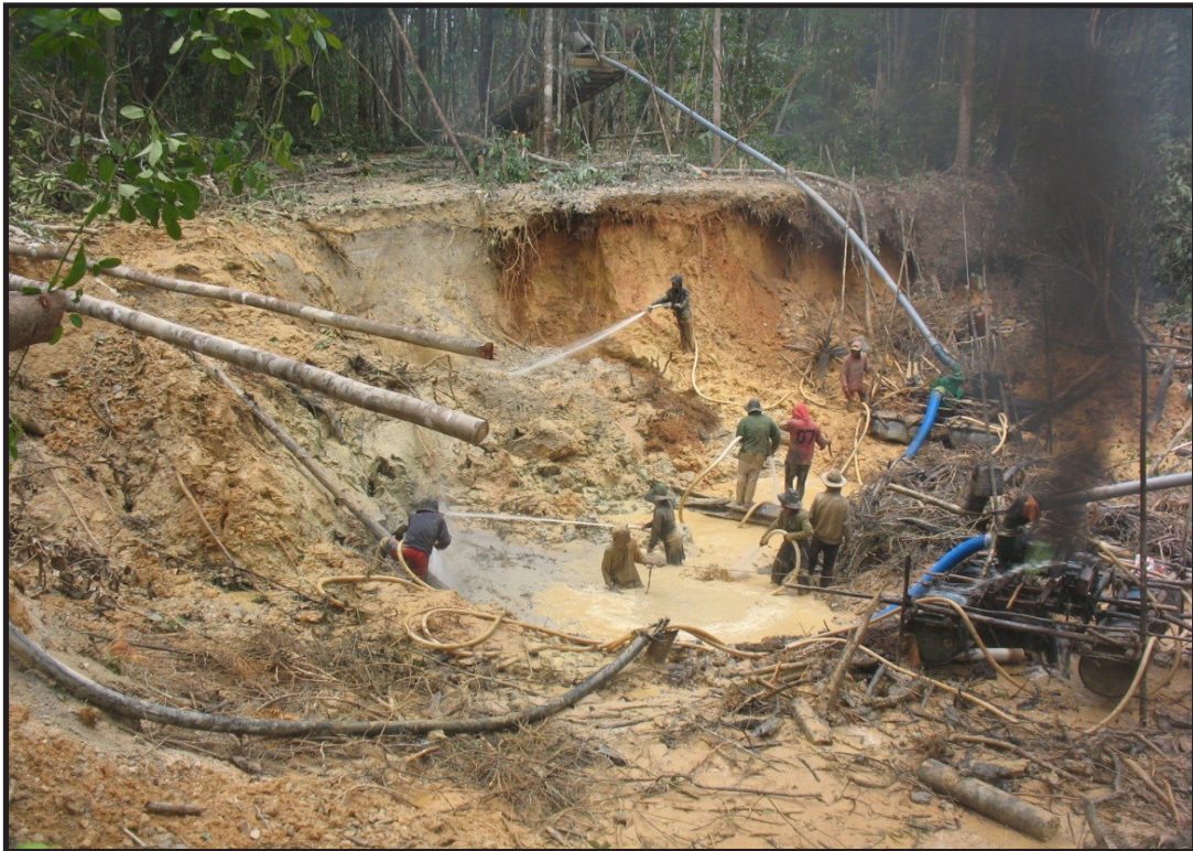
Penambangan emas rakyat pada endapan letakan (plaser) dengan cara disemprot di sebelah barat Bukit Batubelah daerah Pangapit, Kecamatan Subah, Kabupaten Sambas, Provinsi Kalimantan Barat (Irwan Muksin, 2018)
