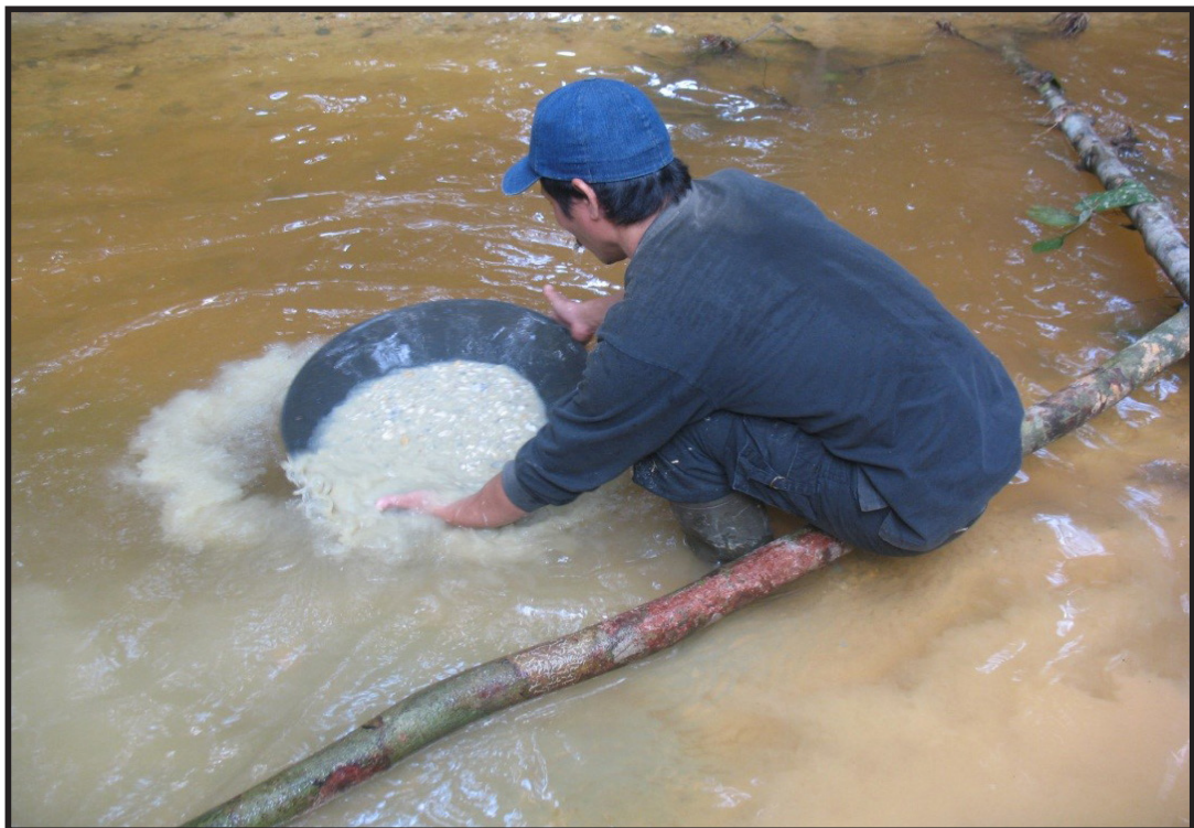
Proses pengambilan contoh konsentrat mineral berat dengan pendulangan dari batuan termineralisasi yang telah dihaluskan, Daerah Pangapit, Kecamatan Subah, Kabupaten Sambas, Provinsi Kalimantan Barat (Irwan Muksin, 2018)
