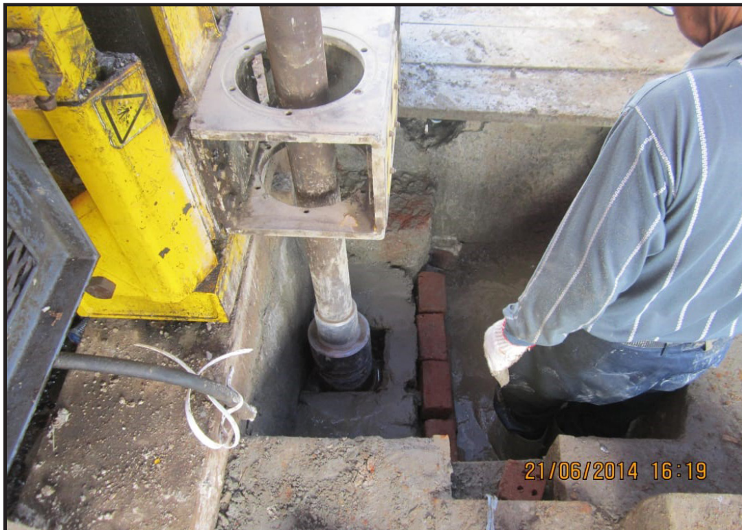
Persiapan pengeboran non corring dengan mata bor tricon 5 5/8 inch, Desa Tanjung Besar, Kecamatan Mekakau Ilir, Kabupaten Ogan Komering Ulu Selatan, Provinsi Sumatera Selatan (Uju Darsita, 2014)
