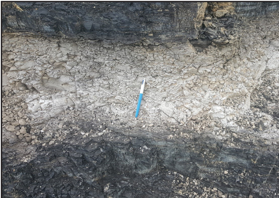
Kenampakan tuffaceous mudstone dalam lapisan batubara di Kabupaten Bengkulu Utara, Provinsi Bengkulu (Sigit Arso Wibisono, 2020)
