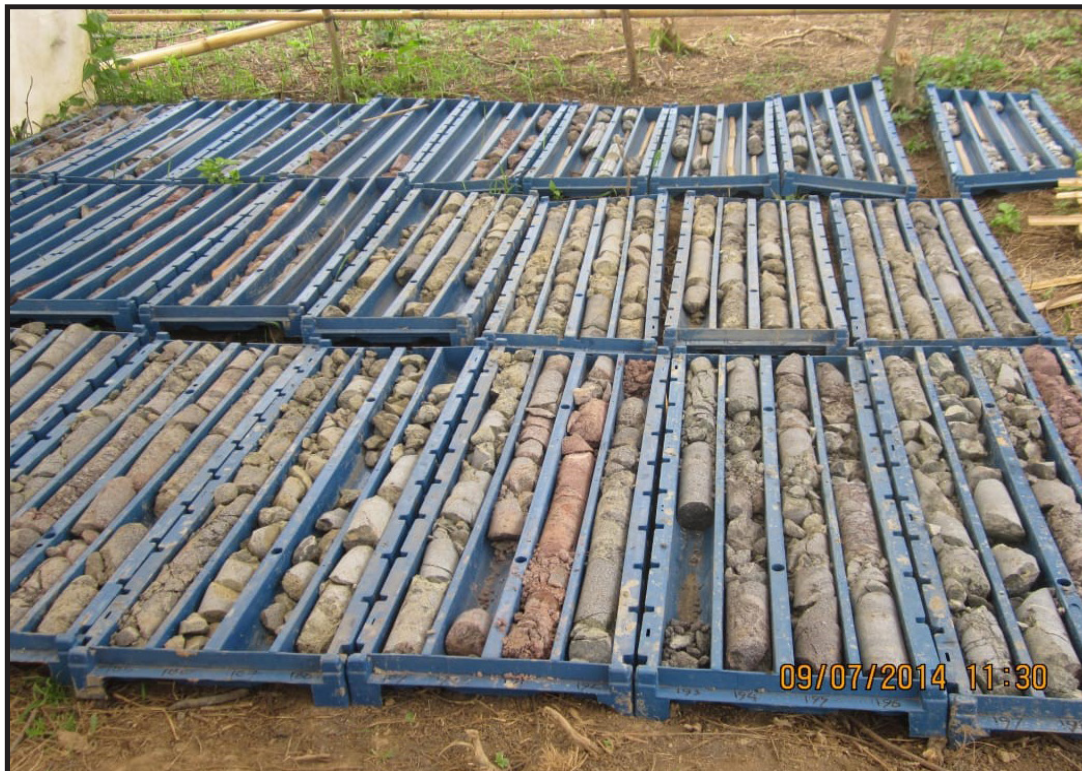
Core box dengan isi contoh batuan hasil pengeboran daerah Way Selabung, Kecamatan Mekakau Ilir, Kabupaten Ogan Kemiring Ulu Selatan, Provinsi Sumatera Selatan (Uju Darsita, 2014)
