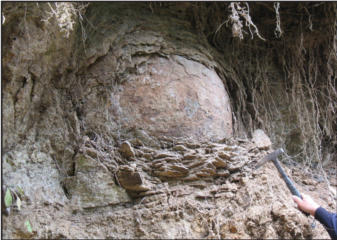
Batuan Andesit yang menunjukkan gejala pelapukan mengulit bawang di daerah Lembang Manggau, Kecamatan Makale, Kabupaten Tana Toraja, Provinsi Sulawesi Selatan (Irwan Muksin, 2014)
