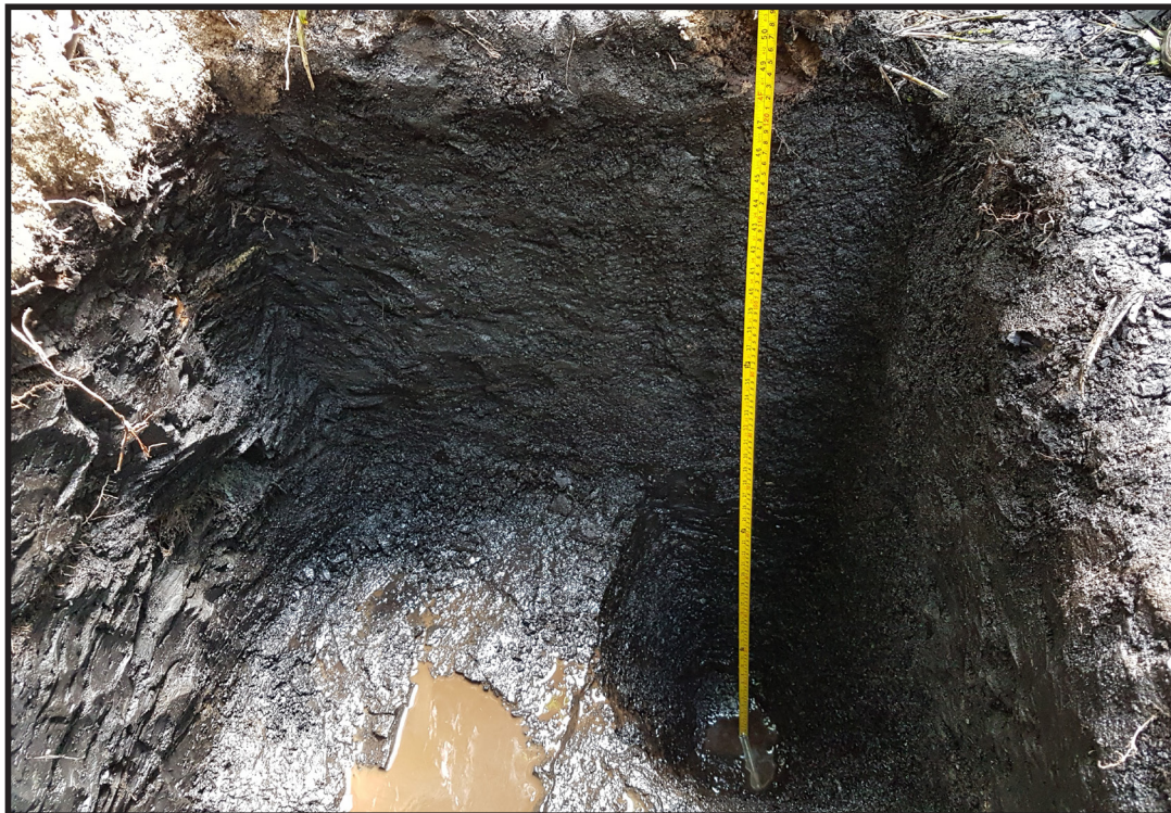
Salah satu kegiatan prospeksi dengan melakukan sumur uji batubara untuk mengetahui ketebalan lapisan batubara, Kabupaten Ogan Komering Ulu, Provinsi Sumatera Selatan (Muhammad Abdurachman Ibrahim, 2018)
