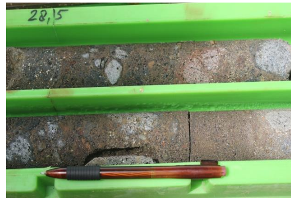
Gambar 7. Inti bor breksi laharik di BH 01 pada kedalaman 28,15 m
