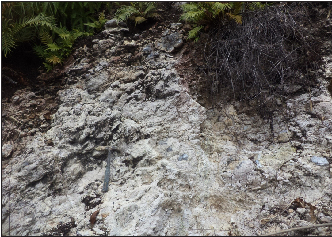
Singkapan batuan di Desa Menge, Kabupaten Bajawa yang telah mengalami ubahan hidrotermal menjadi mineral lempung. Hasil analisis X-Ray Diffraction (XRD) menunjukkan bahwa jenis mineral lempung tersebut berupa montmorilonite dan kaolinite. Kehadiran batuan ubahan dapat mengindikasikan adanya batuan penutup ( clay cap ) pada suatu sistem panas bumi. (Lano Adhitya P, 2017)
