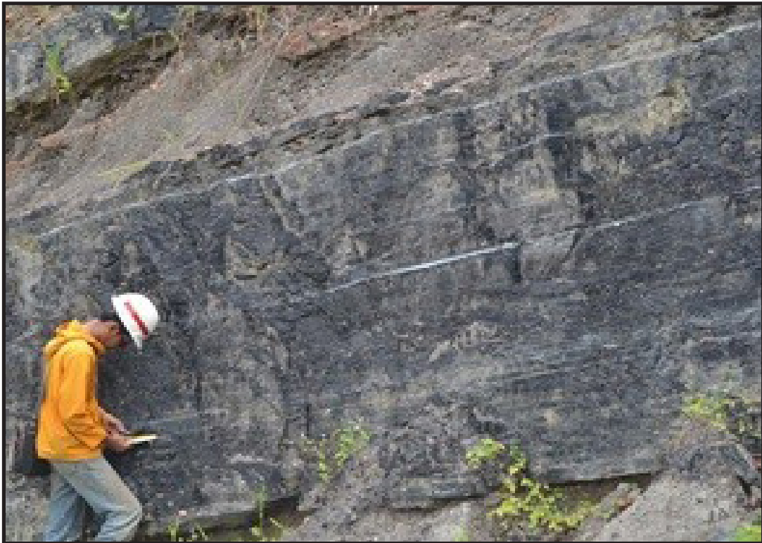
Pengukuran Jurus dan Kemiringan Lapisan Batubara di Formasi Tanjung, Daerah Tabulako, Kabupaten Tanah Bumbu, Provinsi Kalimantan Selatan (Soleh Basuki Rahmat,2018)
