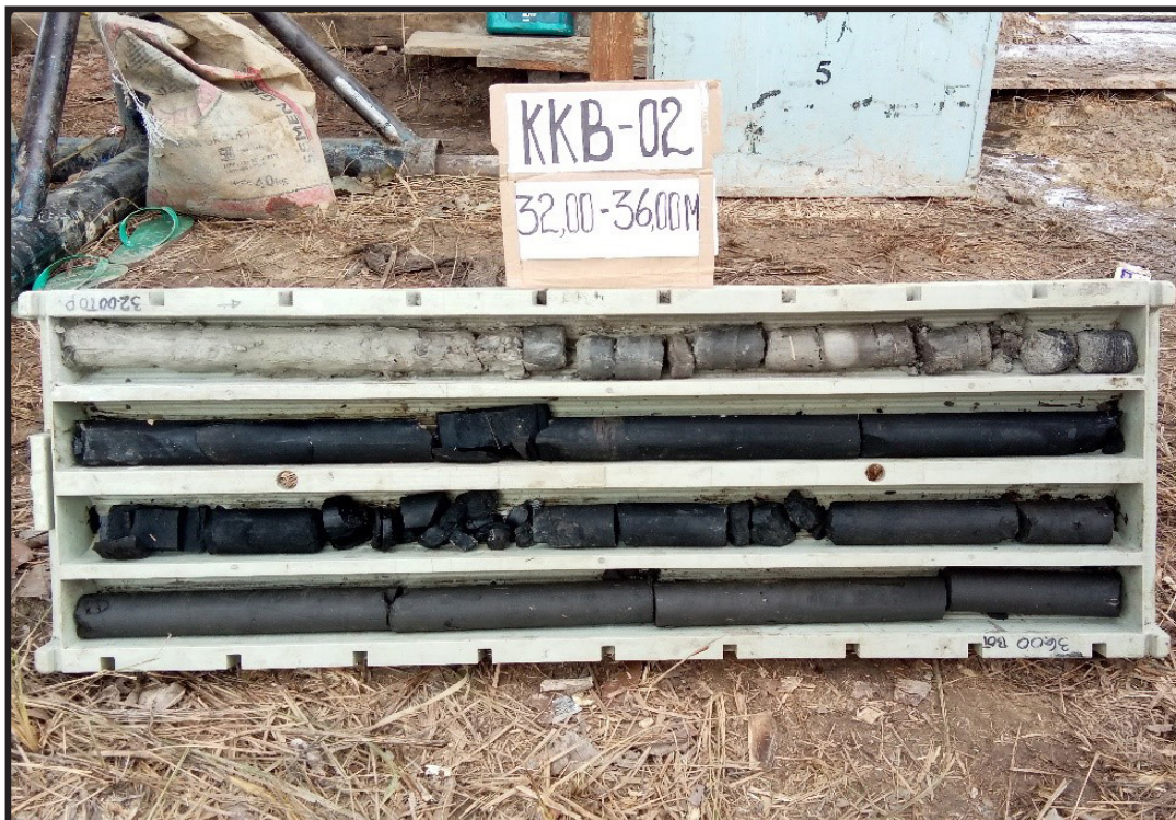
Contoh inti bor sumur KKB-02 pada kedalaman 32,00-36,00 m di Daerah Kuala Kuayan, Kabupaten Kotawaringin Timur, Provinsi Kalimantan Tengah (Sigit A. Wibisono, 2018)
