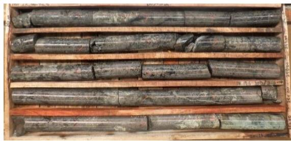
**Gambar 11.** Pada lubang bor nomor A\_01, inti bor kedalaman 256,50 s.d 258,00 meter, memperlihatkan batugamping, teralterasi sedang oleh klinopiroksen - wollastonit, alterasi sedang oleh klorit skarn, pelindian mineral pirhotit, *veinlet* yang terisi pirhotit di kedalaman 257,20 meter, *veinlet* silika di kedalaman 258,00 meter, pirhotit mendominasi, Pb-Zn skarn <1%
