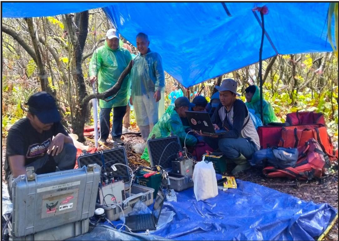
Monitoring Pengukuran Metode Magnetotelurik di Gunung Papandayan, Kab. Garut
