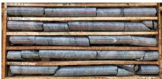
**Gambar 10.** Pada lubang bor nomor A\_01, inti bor kedalaman 90,00 s.d 95,00 meter, memperlihatkan metalimestone, termarmerkan sangat kuat, alterasi klorit sangat lemah, terdapat *veinlet* epidot dan klorit, *veinlet* kalsit-kuarsa di kedalaman 92,75 meter, terdapat pirit
