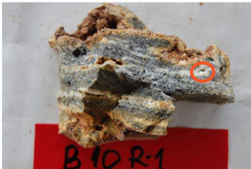
Gambar 9. Contoh batuan tersilisifikasi dengan kuarsa vuggy dan dogteeth (lingkaran merah) dalam satuan batuan sekis di Desa Wumbubangka, Kecamatan Rarowatu Utara Kabupaten Bombana (Tim Prospeksi., 2009)
