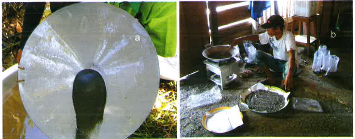
Gambar 2. a. Konsetrat dulang, b. Proses pengeringan conto dengan dipanaskan diatas tungku
