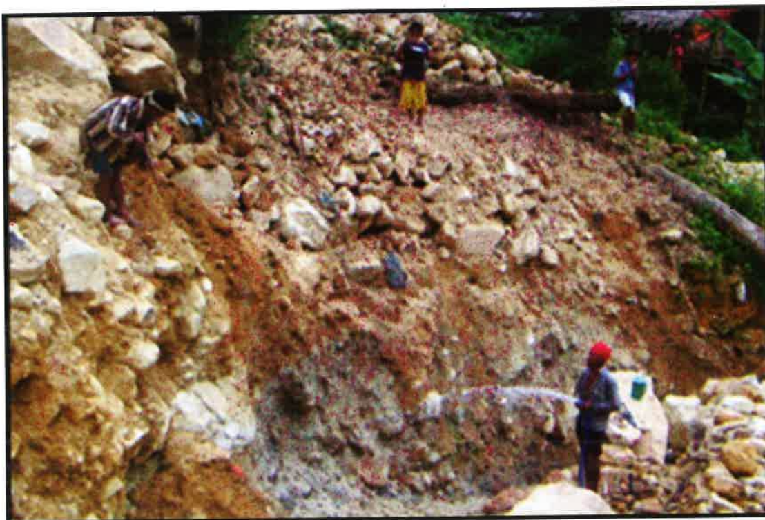
Metode Tambang Semprot pada penambangan emas koluvial di daerah Gunung Pani, Gorontalo (Konservasi-PMG)
