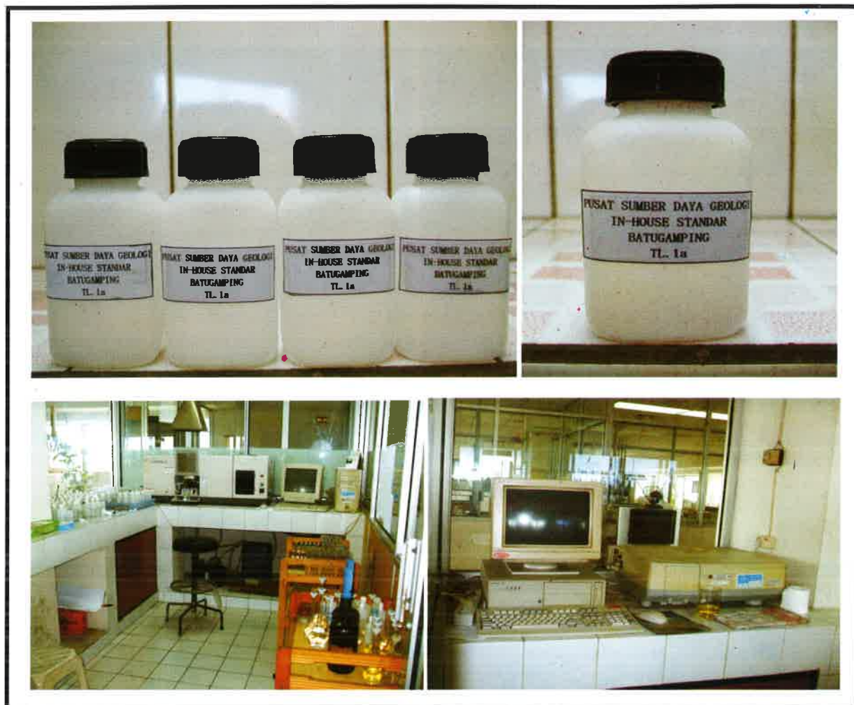
Gambar 17. Hasil Pengemasan in-house standard conto batugamping dan peralatan analisis berupa Atomic Absorption Spectrometer (AAS) dan Spectrofotometer
