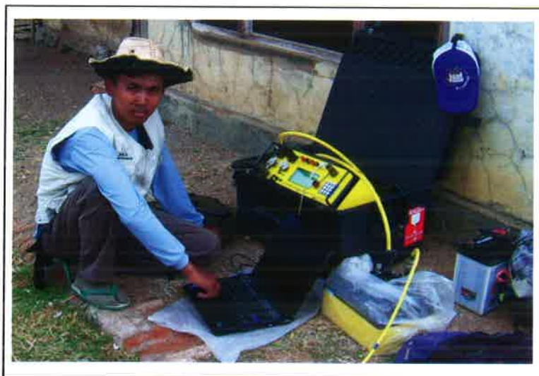
Foto 1. Satu set resistivimeter multichannel Super Sting R8 IP dan satu buah laptop
