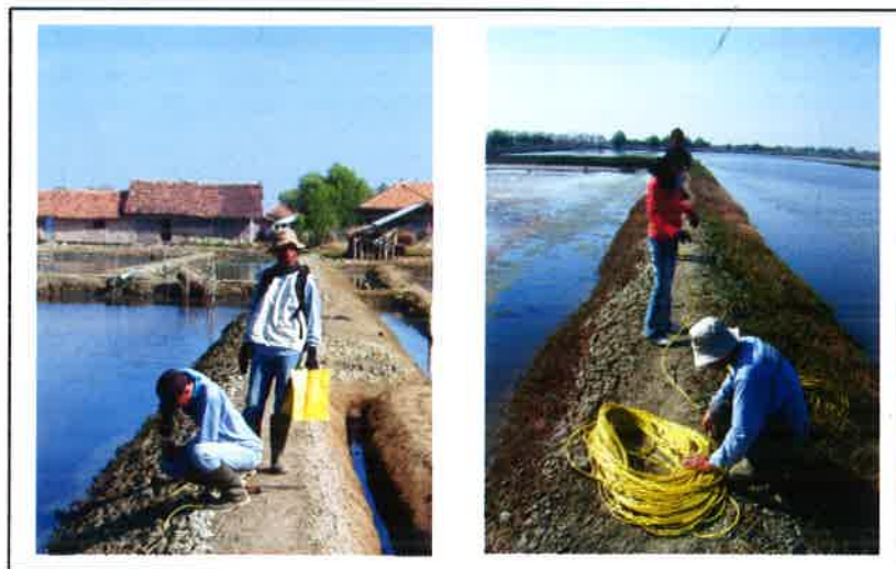
Foto 2. Kegiatan menancapkan elektrode (kiri) dan membenteng kabel (kanan)
