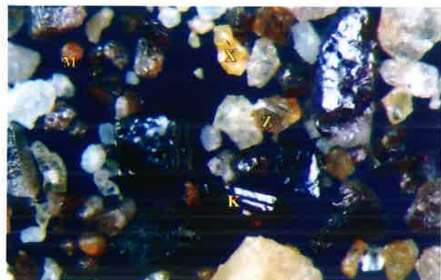
Gambar 4. Konsentrat endapan timah aluvial mengandung zirkon (Z), kasiterit (K), monazit (M) dan xenotim (X), Kampar, Riau, Rohmana dkk, 2006.
