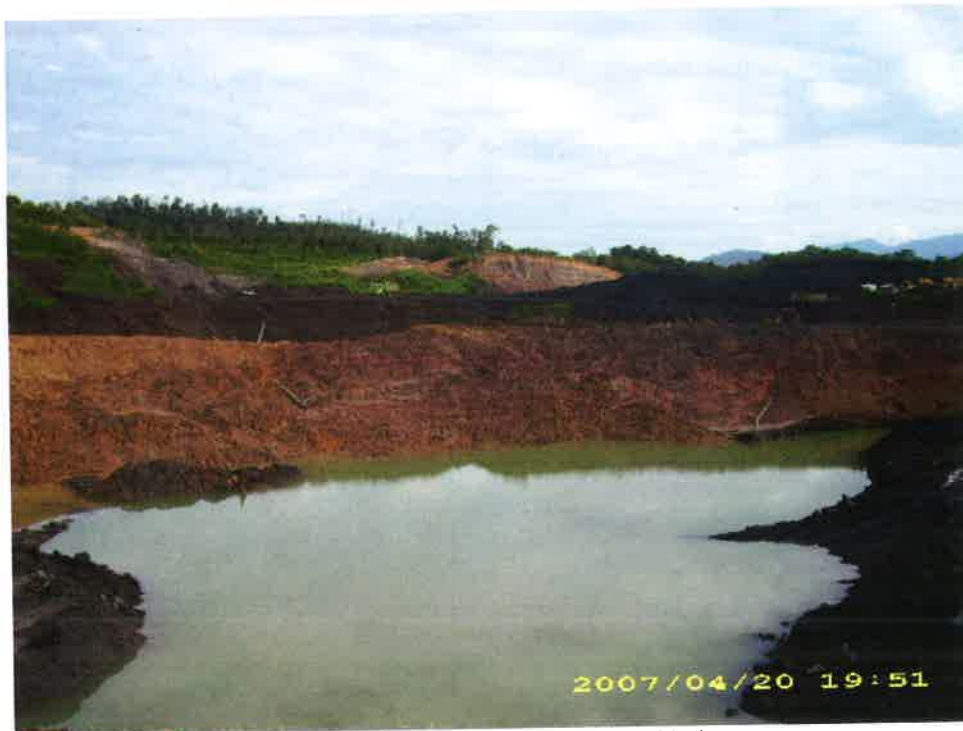
Foto 1. Genangan air yang menjadi kolam, pada tambang batubara di Muara Bungo, Jambi.
