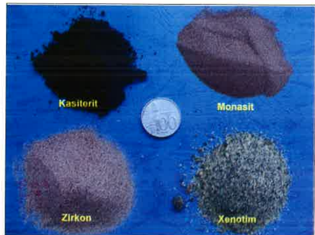
Gambar 1. Mineral kasiterit (SnO 2 ) dan mineral ikutannya, contoh dari Pulau Bangka, Babel (difoto dari contoh koleksi KPP Konservasi).
