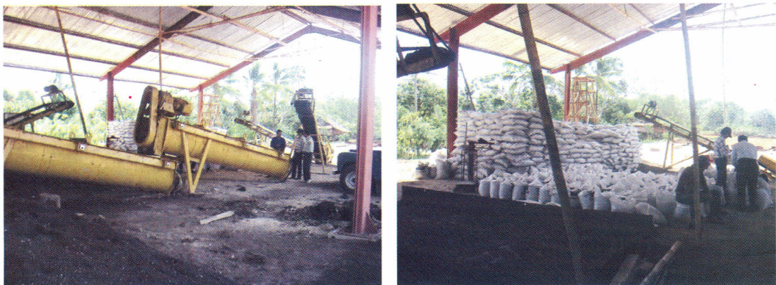
Gambar 5. Pemanas putar untuk menghasilkan BGA (kiri), BGA yang sudah di dalam karung ukuran 40 kg, siap untuk dipasarkan (kanan)
