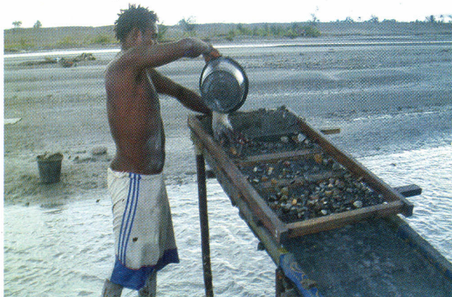
Gambar 3. Pengolahan emas dari tailing tambang tembaga, Mimika, Papua
