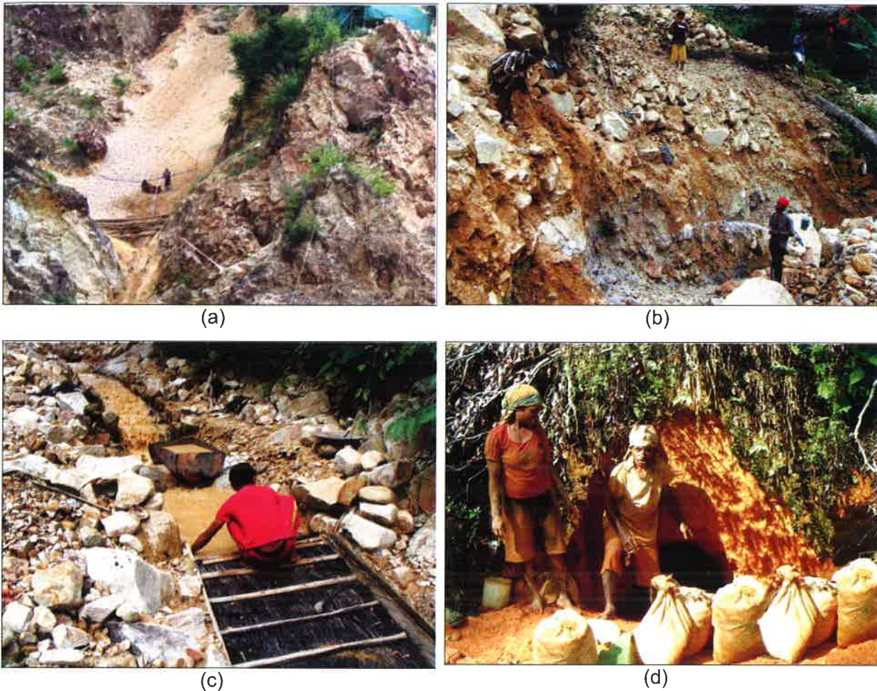
Gambar 5. Tipe cebakan : (a) emas pada tanah lapukan dari cebakan emas primer ditambang dengan cara semprot, G. Pani, Gorontalo; (b) cebakan emas koluviial, G. Pani, Gorontalo; (c) cebakan emas pada alur sungai stadia muda, dan pemasangan Sluice box untuk perangkap emas yang terbawa aliran sungai, G. Pani, Gorontalo; (d) cebakan emas berupa konglomerat alas ditambang dengan cara diterowong, Topo, Nabire, Papua
