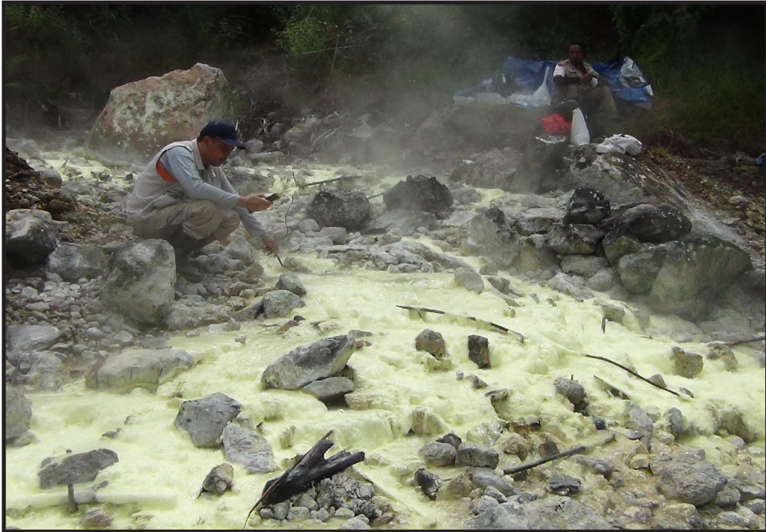
Pengukuran Temperatur Air Panas, Nage, Kabupaten Ngada, Provinsi Nusa Tenggara Timur
