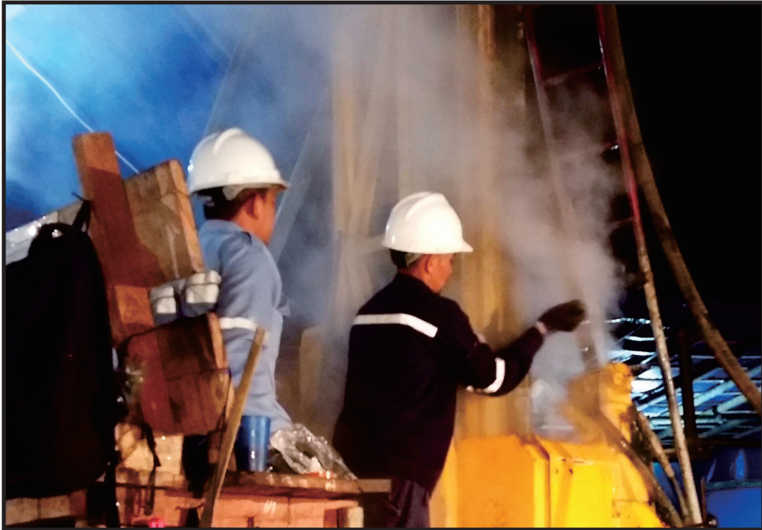
Influx air panas bertemperatur 77°C, debit 60 lpm pada sumur PNT-1, Survei Landaian Suhu Daerah Panas Bumi Panti, Kabupaten Pasaman, Provinsi Sumatera Barat
