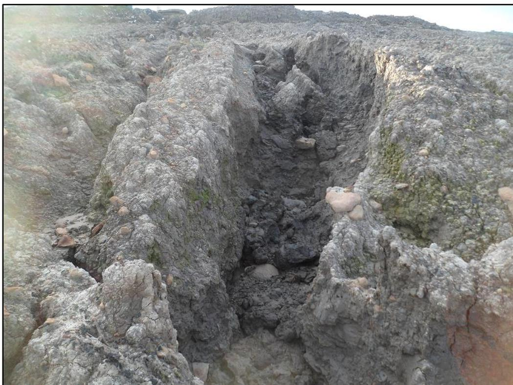
**Gambar 5.** Longsoran dengan jenis *circular failure* pada *disposal area* di daerah penelitian
