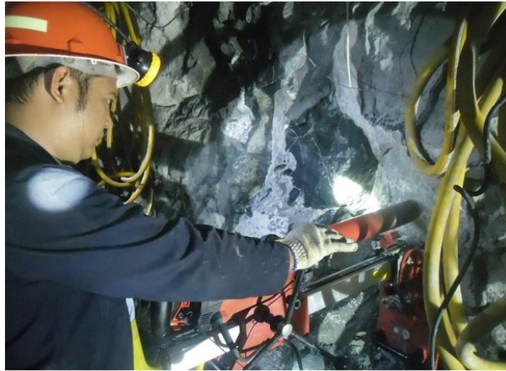
Gambar 6. Pengambilan conto batuan memakai alat bor inti portabel
