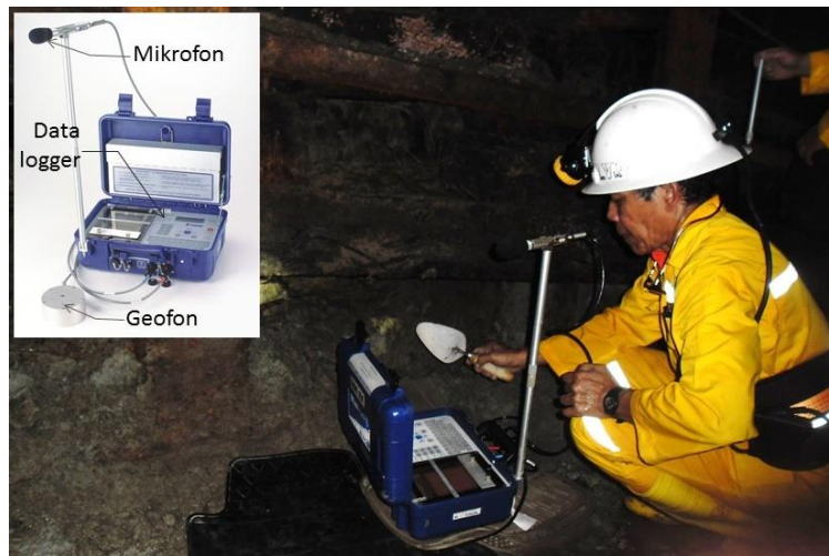
Gambar 7. Pengukuran getaran menggunakan alat Blastmate III
