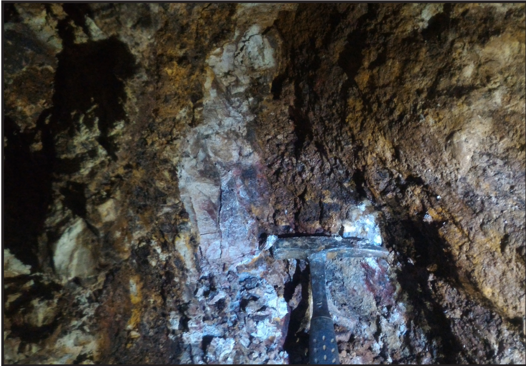
Urat Kuarsa Hematit memotong Batuan Vulkanik teralterasi argilik, Bukit Dolok Pangkuruhan, Desa Kuta Usang, Kabupaten Dairi, Provinsi Sumatera Utara
