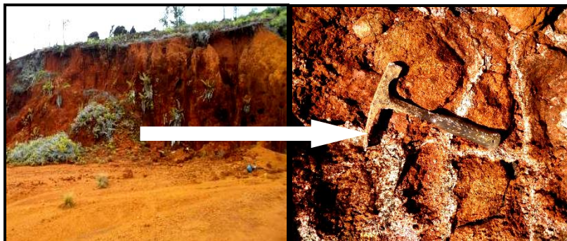
Gambar 6. Endapan laterit pada saprolit (a) yang mengandung boxwork urat silika di daerah penyelidikan
