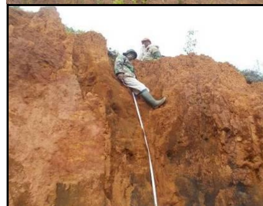
Gambar 2. Pemercontaan dengan menggunakan bor tangan (atas) maupun dengan cara " stripping " atau kupasan (bawah).
