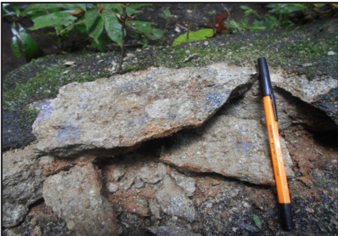
Singkapan satuan batuan breksi tufa di Sungai Panyouhan, Kabupaten Murung Raya, Provinsi Kalimantan Tengah
