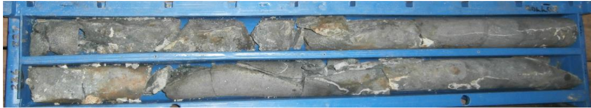
Gambar 5. Litologi high fractured pada kedalaman 236,00 m - 237,00 m, serta merupakan zona milonitisasi
