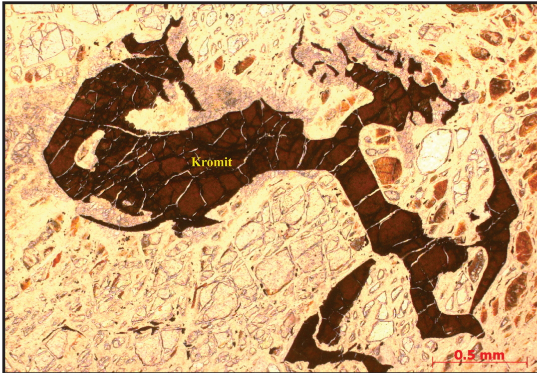
Fotomikrografi sayatan tipis batuan ultramafik terdapat mineral logam kromit, dari Daerah Pomalaa, Sulawesi Tenggara. Posisi Paralel Nikol, menggunakan lensa okuler 10X dan Oby 2,5 X (Sukaesih, 2015)
