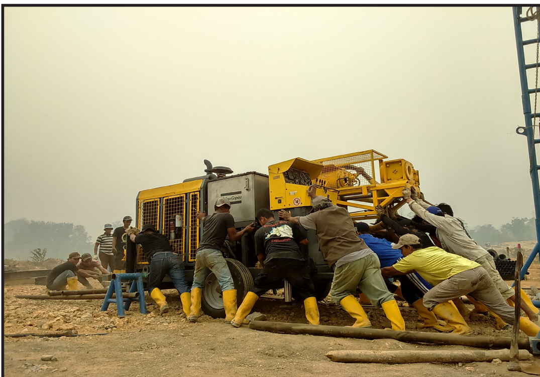
Proses menurunkan mesin bor untuk persiapan pemboran dalam CBM dan Batubara di Daerah Tamiang Layang, Kabupaten Barito Timur, Provinsi Kalimantan Barat (Raden Maria Ulfa, 2015)
