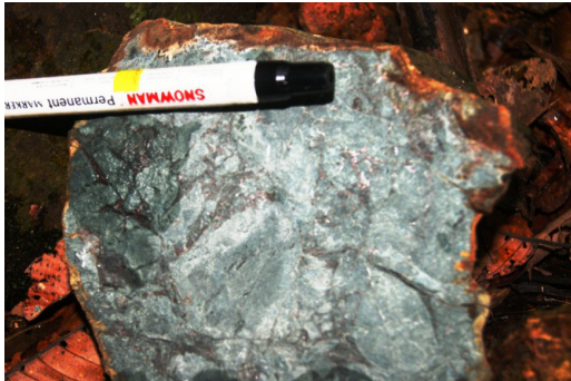
Gambar 5. Float breksi tufa terpropilitkan (RK14-19F) dengan pemineralan pirit dan kalkopirit (Anonim, 2014)
