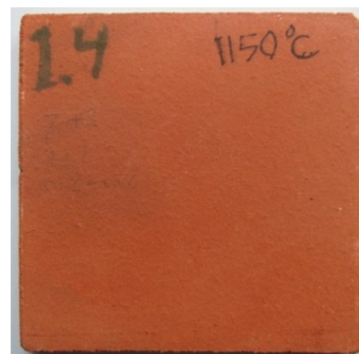
Hasil suhu pembakaran 1.050°C Hasil suhu pembakaran 1.150°C Lempung desa Simpang Sender Utara (50%) + Tuf Feldspatik desa Simpang Sender Utara (50%) (Prototipe 1)
