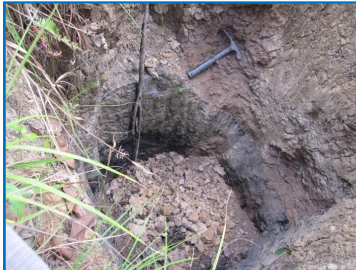
Gambar 3. Singkapan lempung sedimen Formasi Muaraenim, di daerah sekitar IUP Eksplorasi batubara PT. Anugrah Energi diambil dari lubang sumur uji
