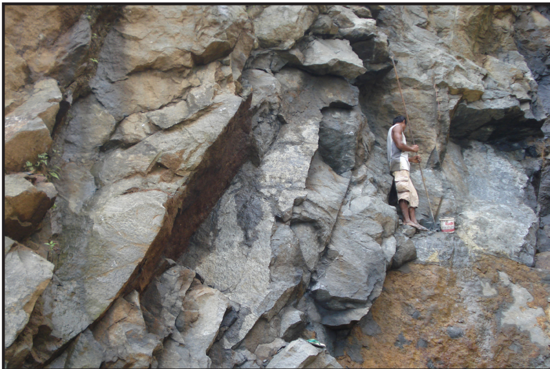
Gambaran profesi pemecah batu di Gn. Parang Karangsambung Kebumen, pekerja sedang memampatkan bahan peledak kedalam lubang tembak sebelum peledakan menggunakan batang bambu. (Untung Triono, 2013)
