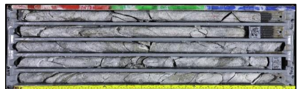
Gambar 5. Vulkanik andesit, abu-abu gelap, afanitik, teralterasi kuat oleh silika, diaspor, dan pirofilit, mineralisasi berupa urat pirit (GTD-778 ; 421,8 – 426,08 meter)
