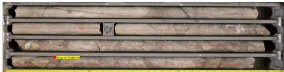
Gambar 6. Breksi Preatomagmatik 1 (BXg 1), abu-abu, polimik, sub angular, teralterasi kuat alunit dan silika, fragmen: andesit teralterasi dan silika. (GTD-727; 299,82 – 303,2 meter)
