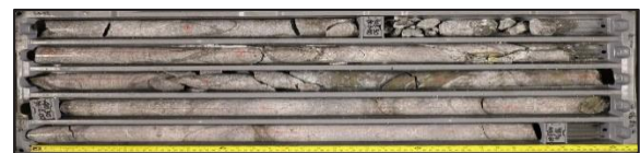
Gambar 8. Diorit (IPDi), teralterasi kuat berupa silika, dan alunit, pirit open space filling . (GTD-727 ; 403,7 – 407,78 meter)
