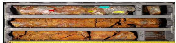
Gambar 9. Breksi Preatomagmatik 2 (BXg 2), coklat kemerahan, clast supported , very coarse grain , teralterasi kuat oleh dickit, teroksidasi oleh goethit (GTD-727 ; 72.04 – 74.2)
