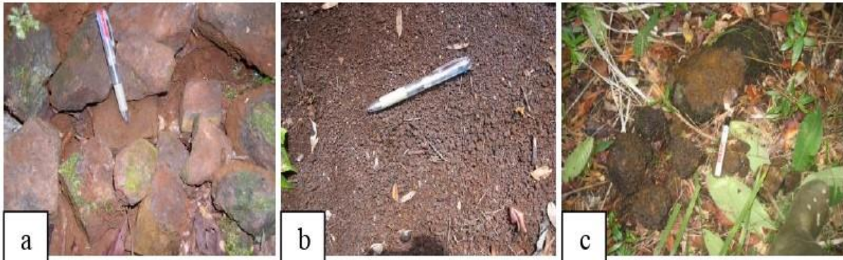
Gambar 8. (a) Bongkahan bijih besi pada zona lateritik A berupa hematit/gutit/magnetit di daerah Bukit Belah lokasi TB. 1206. (b) Fragmen bijih besi berupa hematit/gutit berukuran granule pada zona laterit B lokasi TB 1408. (c) Bongkahan bijih besi berupa hematit/ goetit pada zona lateritik C lokasi TB. 0306.
