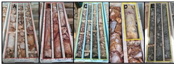
Gambar 15. Alterasi pada daerah penelitian. (A) Silika Vuggy , (B) Silika masif, (C) Silica advanced argillic , (D) Clay advanced argillic , (E) Argilik
