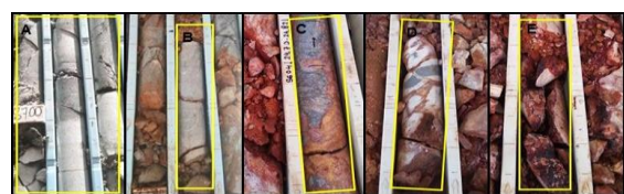
Gambar 17. Tingkat oksidasi di daerah penelitian. (A) tidak teroksidasi, (B) teroksidasi lemah, (C) teroksidasi sedang (D) teroksidasi kuat, (E) teroksidasi sempurna
