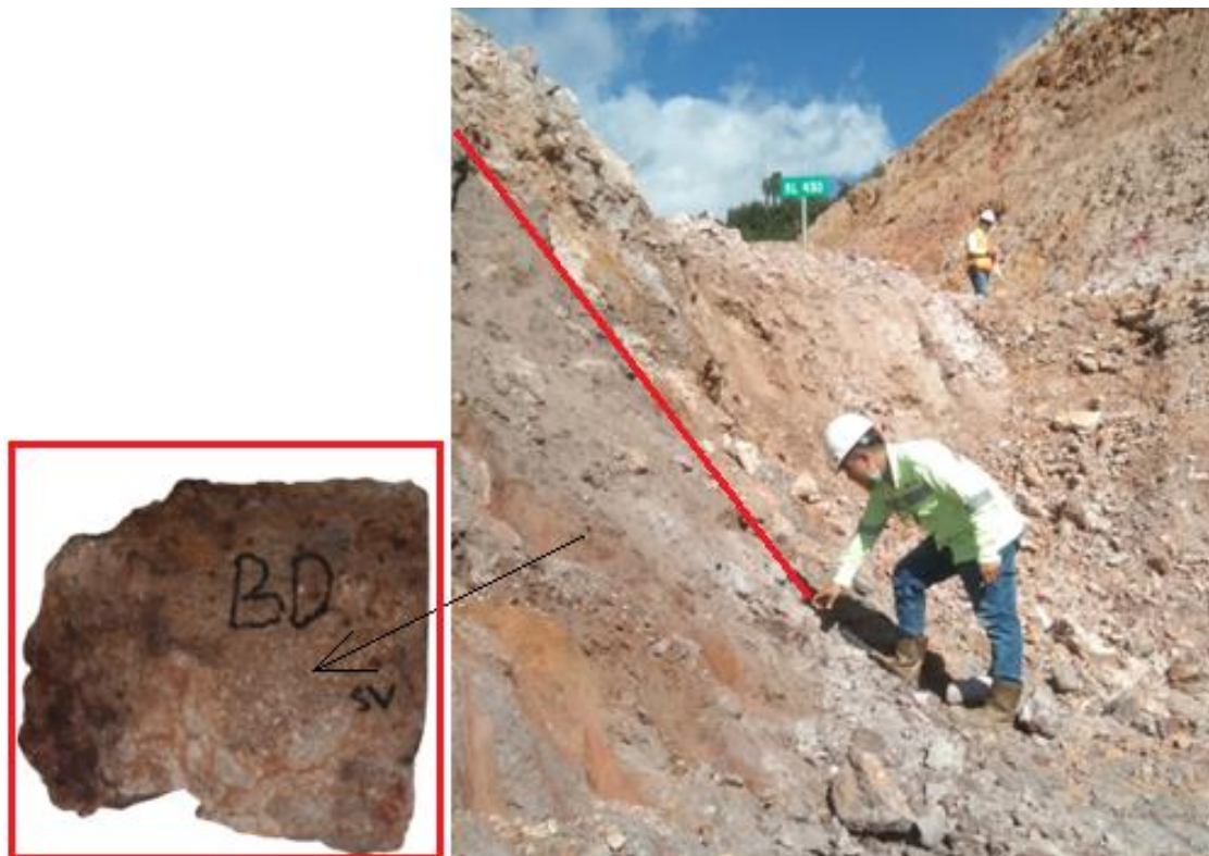
Gambar 3. Singkapan alterasi dan hasil grab sampling
