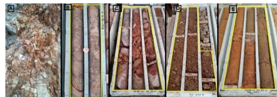
Gambar 14. Litologi pada daerah penelitian. (A) Singkapan breksi sesar, (B) Breksi hidrotelmal, (C) Breksi diatrem, (D) Scree, (E) Tanah
