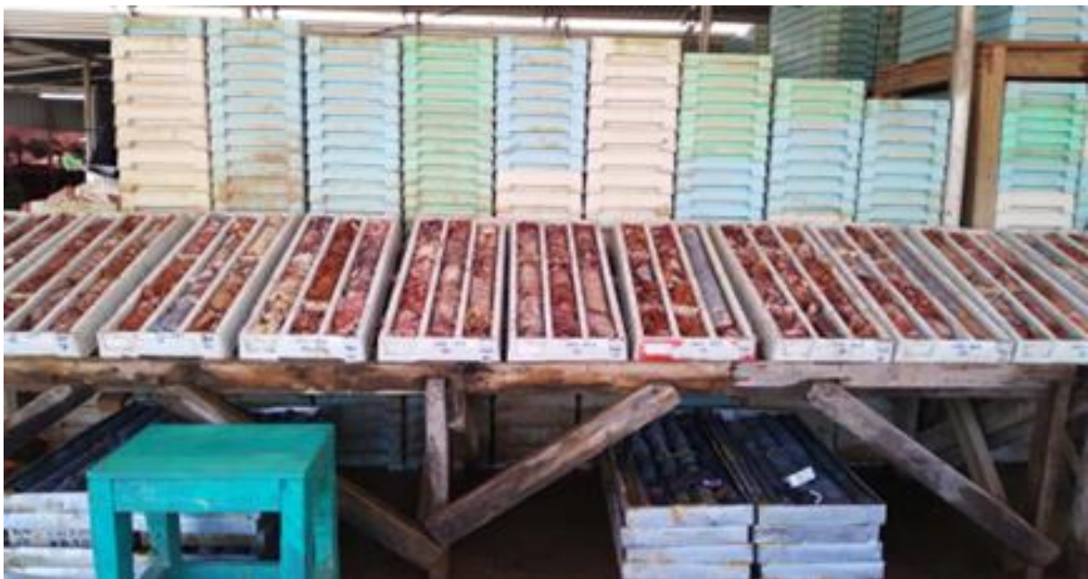
Gambar 5. Sample inti bor pada daerah X
