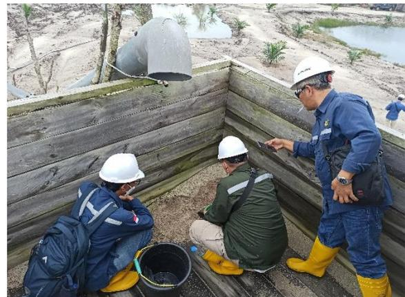
**Gambar 6.** Pengambilan sampel konsentrat dulang di *sluice box*
